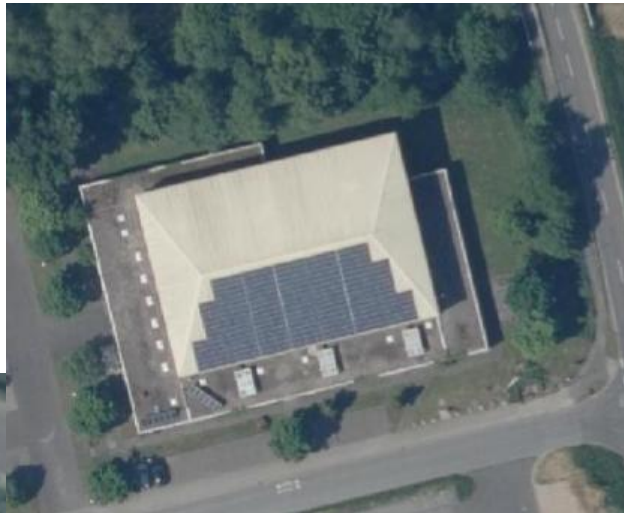
7 Dach-PVA der Gemeinde Installierte Leistung: ca. 215 kWp Ø-Jahresertrag: ca. 215 MWh
