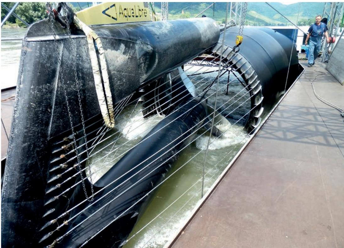
Abbildung 19: Strom-Boje mit einer Länge von neun Metern (Quelle: Fa. Aqua Libre, Wien/AT)
