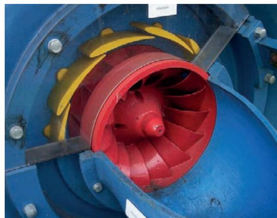
Abbildung 16: Francis-Turbine Schaufeln eingestellt auf minimale Leistung (Quelle: Stahlkocher, creative commons)
