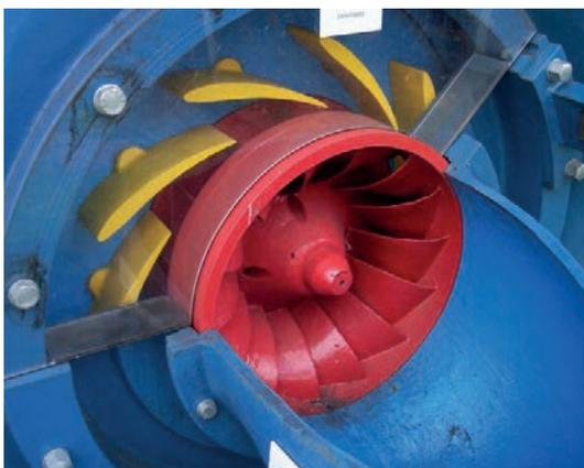
Abbildung 15: Francis-Turbine. Schaufeln eingestellt auf maximale Leistung (Quelle: Stahlkocher, creative commons)
