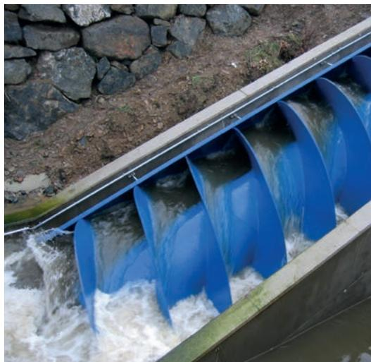
Abbildung 20: Beispiel einer Wasserkraftschnecke aus dem Wasserkraftwerk Wilhelmshütte 60 kW, Jahresenergie 0,25 GWh, 70 Haushalte (Quelle: Dr. Ronald Steinhoff)
