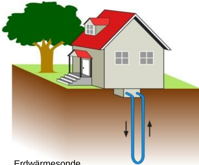
Erdwärmesonde (ca. 9.100 Anlagen)
