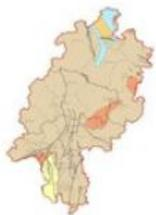
**Themenlayer mit auf unterschiedliche Tiefenniveaus bezogenen Horizontalschnitten zur Geologie. Hier: Geologische Übersichtskarte („Horizontalschnitt“) für das Höhenniveau -1000 mNN**
